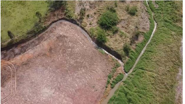
Figuras acima com pontos de obstrução das calhas e vegetação alta reduzindo a capacidade de vazão e escoamentos da rede hidrológica local.
